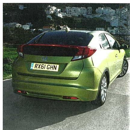
Tak poznáte diesel: malé spoilery na zádi posunuly víření vzduchu a umožnily naměřit kýžené emise CO 2 na limitu 110 g/km
