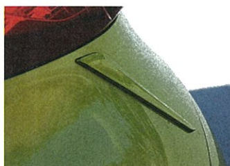
Tak poznáte diesel: malé spoilery na zádi posunuly víření vzduchu a umožnily naměřit kýžené emise CO 2 na limitu 110 g/km
