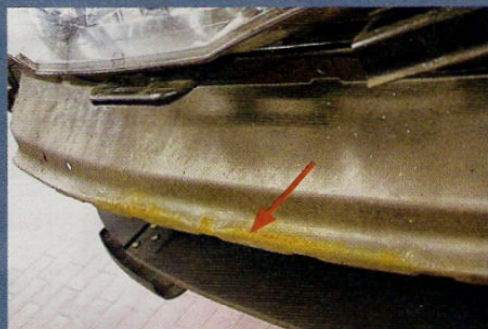
Přední spoiler a příčník se o sebe při jízdě odíraly, přesto na některých místech ještě zůstal zachovaný ochranný nátěr. Toto místo však podle odborníků vyžaduje konstrukční úpravu.
