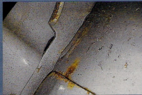
Práh dveří testovaného automobilu byl zvnějšku i uvnitř dostatečně konzervovaný s výjimkou jediného místa v nosníku vzadu vpravo. Tady endoskop odhalil viditelné stopy po korozi.
